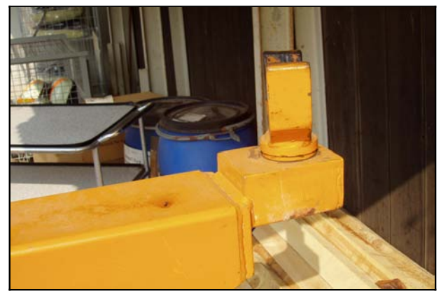
Kranarm mit vorderer Aufnahmegabel zur Aufnahme der Rundbügel an Schutzcontainern
