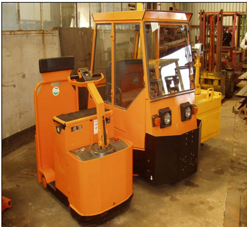
Still R6-Schlepper, stabile Blechkonstruktion mit Anhängerkupplung in verschiedener Deichselhöhe
