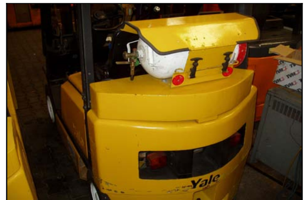
abgerundetes Heck mit Zusatzgewicht 500 kg
