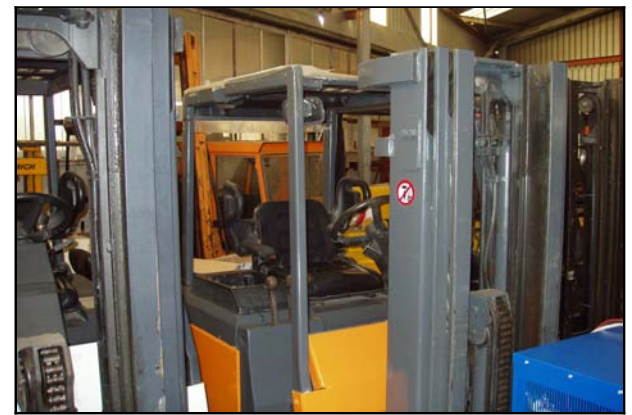
kleiner Platzbedarf, stabile Bauart mit Triplex-Freihub-Mast
